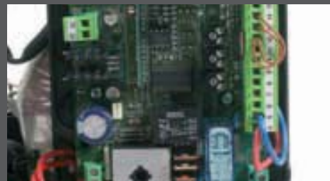
Receptor bicanal integrado entradas para apertura peatónal
